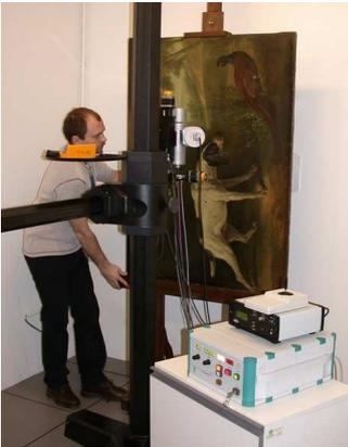
La spectrométrie de fluorescence X permet l'analyse élémentaire non invasive des œuvres.
